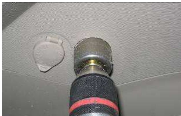
ФРЕЗА ДЛЯ ПЛАСТИКУ BF11 Ø39.5mm
