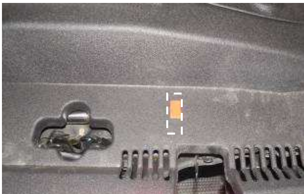
ВЫРЕЗАТЬ ОТВЕРСТИЕ В ПАНЕЛИ
