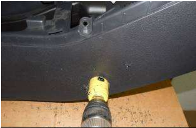
ФРЕЗА ДЛЯ МЕТАЛУ BF 35 Ø 35mm
