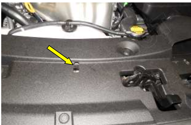
ВИРІЗАТИ ОТВІР ДЛЯ КРОНШТЕЙНА
