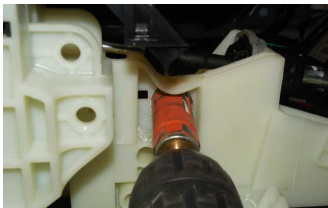
ФРЕЗА ДЛЯ МЕТАЛУ BF-1 Ø 22mm
