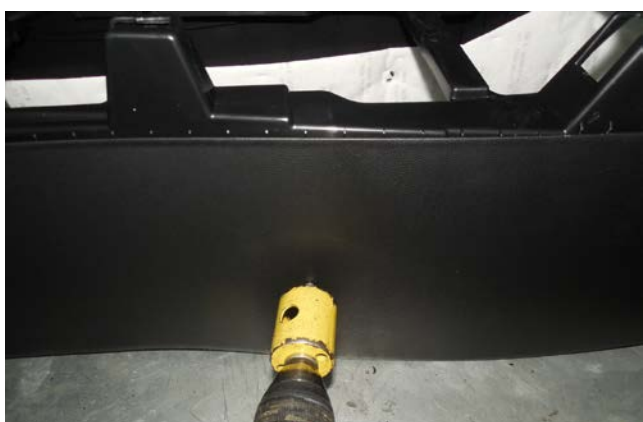
ФРЕЗА ДЛЯ ПЛАСТИКУ BF11 Ø39.5mm
