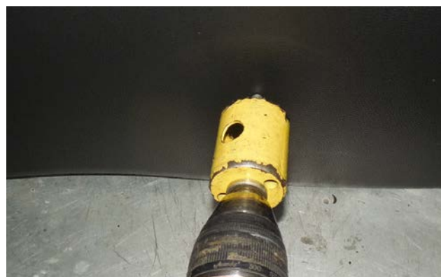
ФРЕЗА ДЛЯ ПЛАСТИКУ BF11 Ø39.5mm
