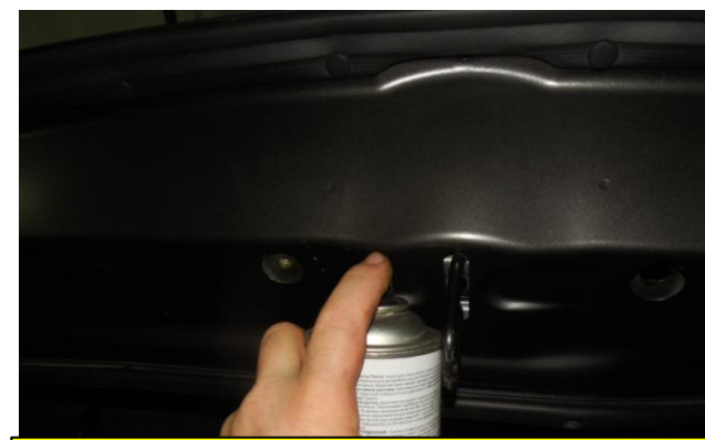
ОБРОБИТИ ОТВІР АНТИКОРОЗІЙНИМ ЗАСОБОМ
