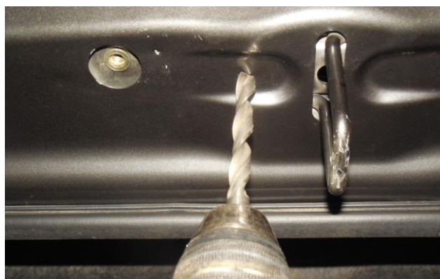
ПРОСВЕРДЛИТИ ОТВІР Ø 9 mm
