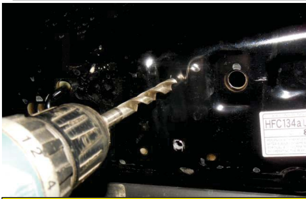
ПРОСВЕРДЛИТИ ОТВІР Ø 9 mm
