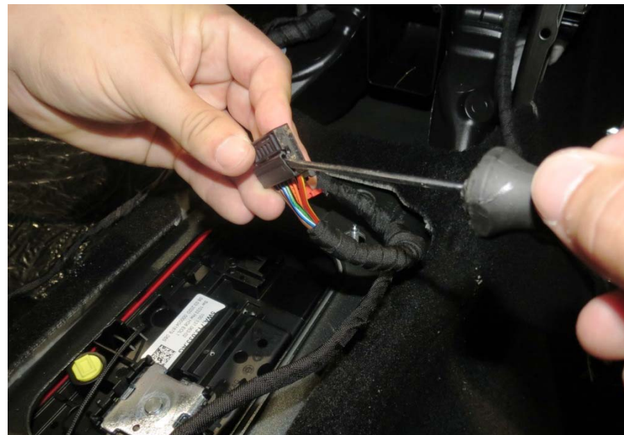
Vycvakněte pojistku konektoru
