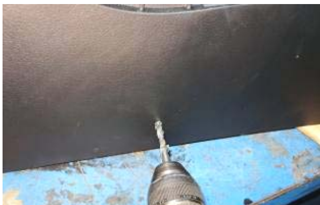
ПРОСВЕРДЛИТИ ОТВІР Ø 6,8mm
