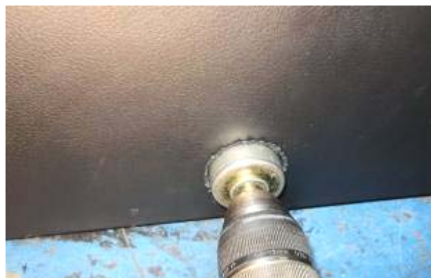
ФРЕЗА ДЛЯ ПЛАСТИКУ BF43, Ø 30mm
