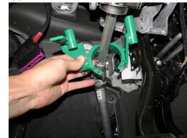
14a - elektronická regulace polohy volantu
